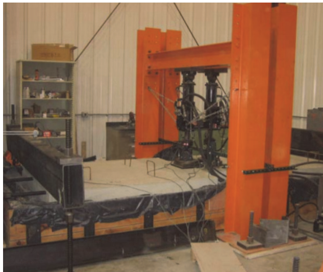
Slika 2. Postav ispitivanja u velikom mjerilu za ocjenu učinkovitosti prijenosa opterećenja [19]
